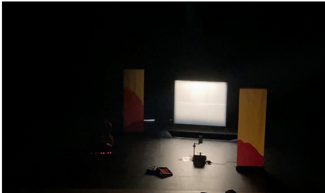
9 / Découpe 1kW grand angle type 25-50 +diff132 Tableau Découpe sur le tableau, plutôt en douche pour ne pas avoir l'ombre d'Hortense quand elle dessine
